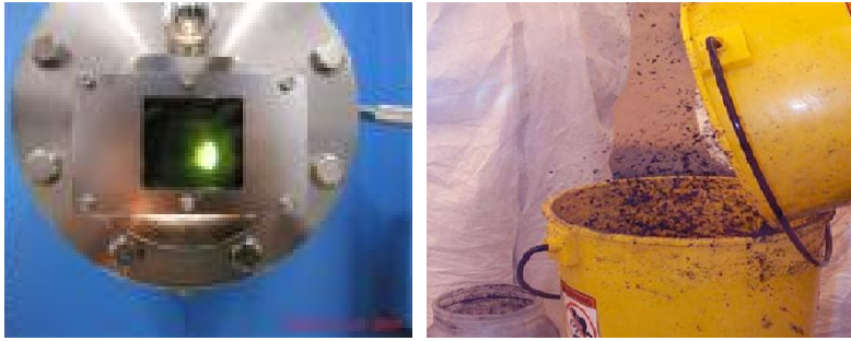
Figur 2. Til venstre det indesluttede system, hvori nanorør kan fremstilles. Til højre ses affald fra fremstillingen: de usynlige nanorør har tendens til at klumpe sig sammen og danne synlige strukturer i form af ekstremt lette, nærmest svævende sorte fnug.
