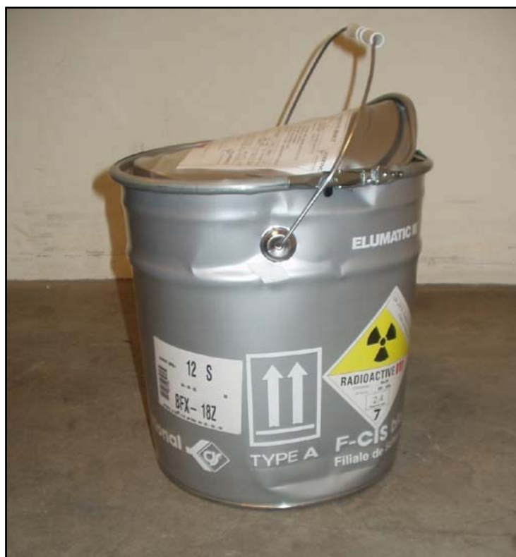
Figur 6 Beskadiget type A kolli i Københavns Lufthavn
