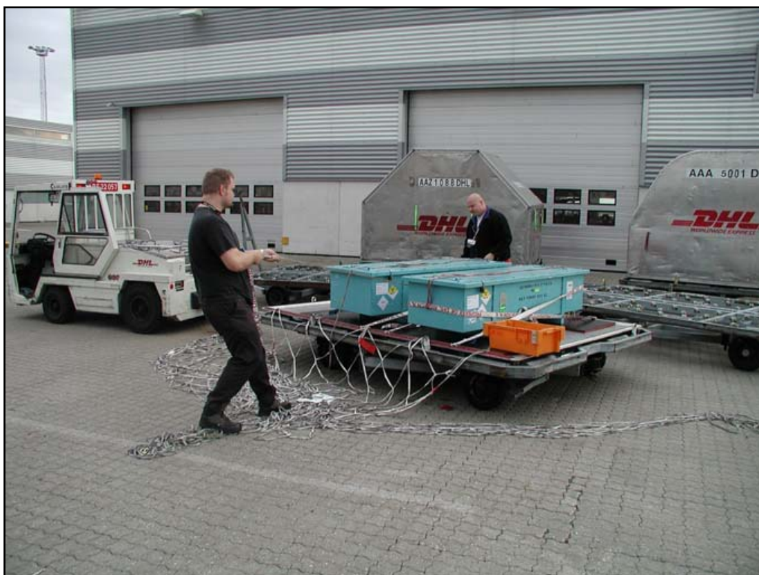
Figur 3 Ubestrålede forsøgsreaktorbrændselselementer i Københavns Lufthavn lastes i flypallette (ULD, Unit Load Device)
