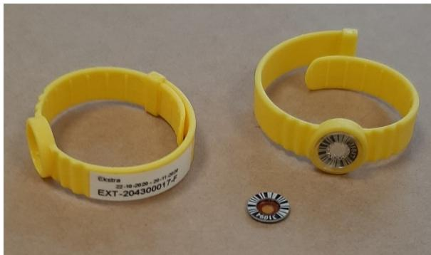
Selve dosimterelementet, der er af Harshaw DXTRAD™-typen, er en lille metalring med polyimidmateriale (Kapton™) og et tyndt lag strålefølsomt termoluminiscent lithiumfluorid pulver. Elementet er dækket af et fladtrykt plastdome med et tyndt vindue yderst. Elementerne har individuelle stregkoder og er produceret af Harshaw™, som er en del af Thermo Fisher Scientific.
